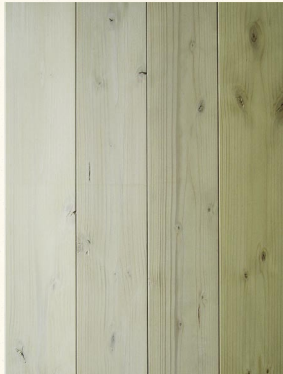
20%, 10%, 5% Titanweiß in GekkoSOL Lasur ganz rechts: unbehandeltes Holz zum Vergleich
